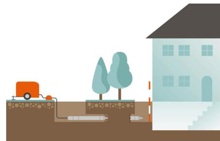
3. Bei den anschließenden Montagearbeiten im Haus werden die Glasfasern in die Leerrohre eingepulst und die Glasfaserdose innerhalb der Immobilie installiert. Ab dem Zeitpunkt kann der Router des Telekommunikationsanbieters angeschlossen und der Anschluss durch den Vermarktungspartner geschaltet werden.
